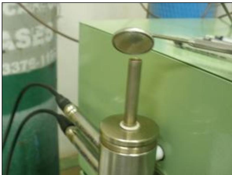
Fig. 16 – Espelho embaçado, indicando que a chama do FID está acesa.
