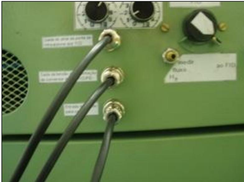
Fig. 6 – Conectores, dos cabos de 4, 5 e 8 contatos, situados no painel de tras.
