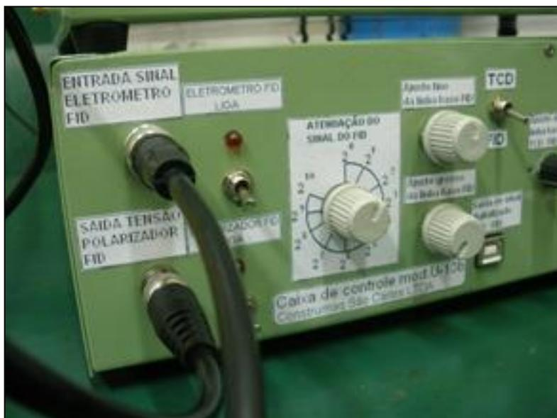
Fig. 7 – Conexão dos cabos co-axiais, no painel da frente.
