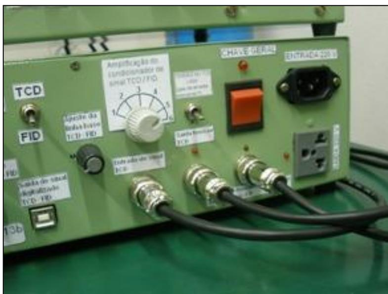
Fig. 5 – Conectores, dos cabos de 4, 5 e 8 contatos, situados no painel frontal.
