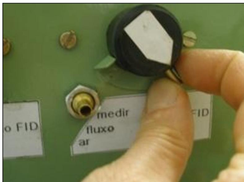
Fig. 13 – Pinçando o pino do knob, na posição “ao FID”, contra a trava.
