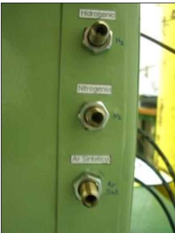
Fig. 4 – Entrada das tubulações dos gases (rosca M8).
