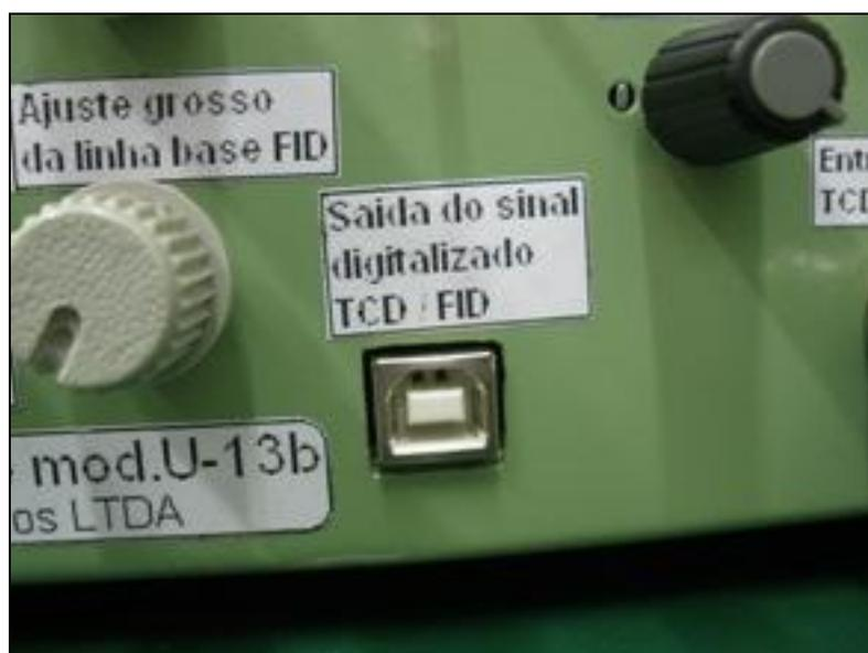
Fig. 11- Conector USB, no painel frontal da caixa de controle.
