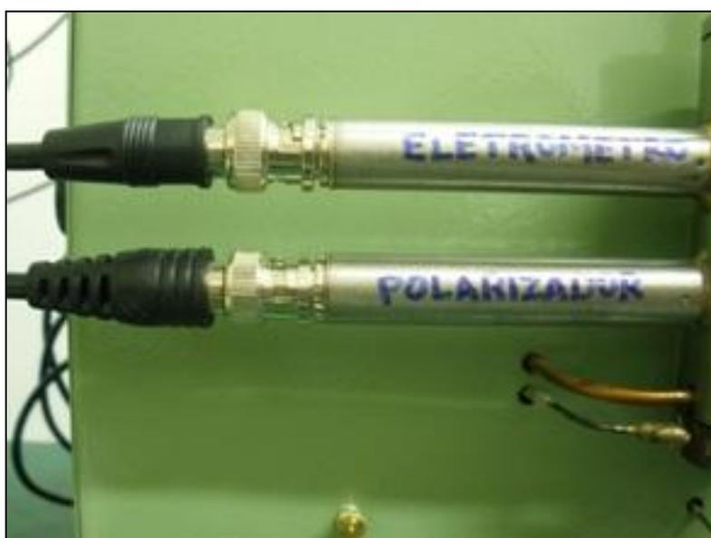
Fig. 8 – Conexão dos cabos co-axiais, nos contatos do FID.
