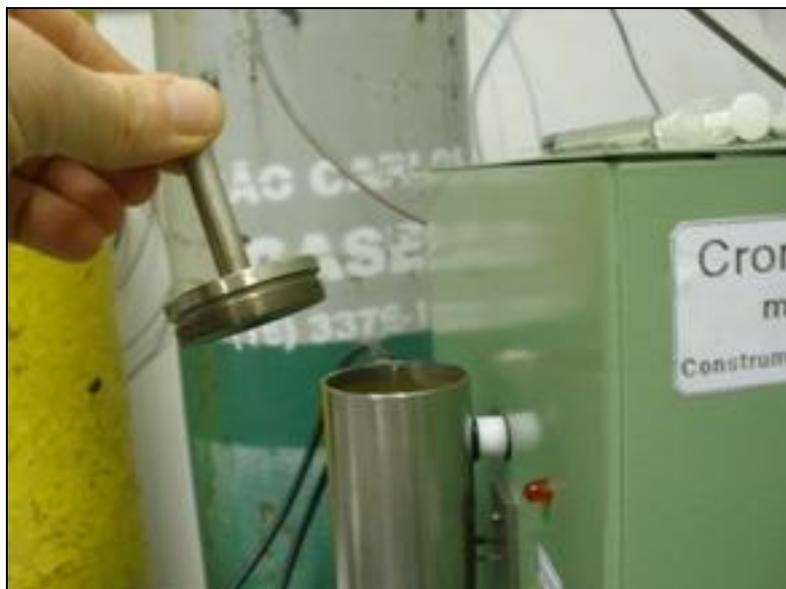
Fig. 15 – Ao se colocar o cromatógrafo em funcionamento para escrever estas instruções, ao chama do FID somente acendeu após a tampa do FID ser tirada (provavelmente devido à entrada de mais ar dentro do compartimento da chama do FID).
