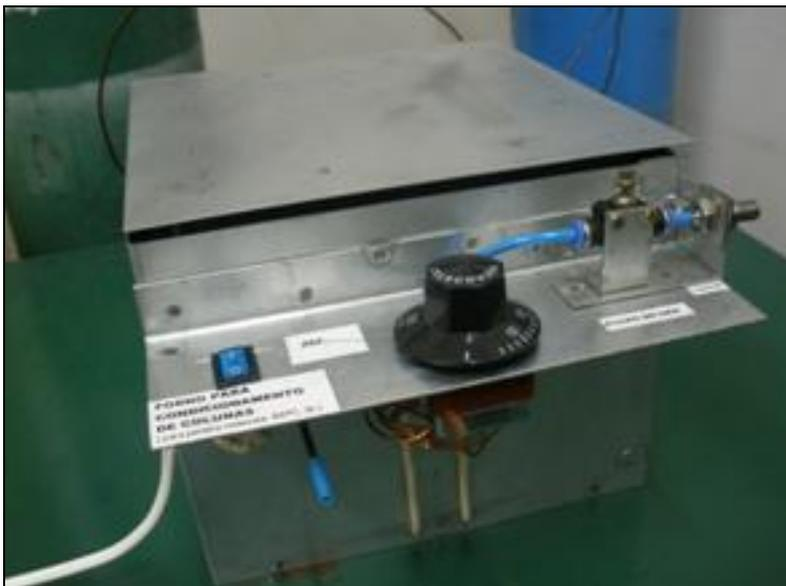
Fig. 3 – Forno para condicionamento da coluna Tamiz molecular.
