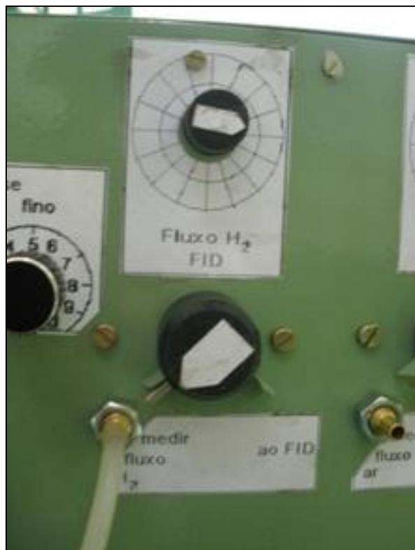
Fig. 12 – Mangueira de silicone do bolhometro conectado, e knob na posição de medir fluxo de  $H_2$ .
