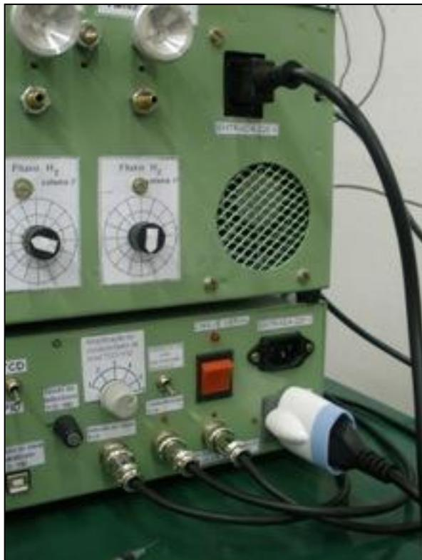
Fig. 9 – Cabo de força, entre caixa de controle mod. U-13b e cromatógrafo.
